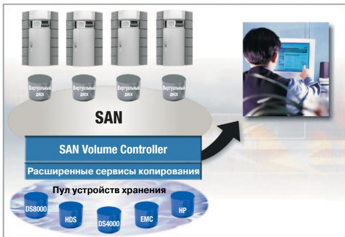
Решение IBM System Storage San Volume Controller (SVC) предназначено для виртуальной консолидации емкости различных систем хранения. Оно обеспечивает общие функции копирования, позволяет перемещать данные, не прерывая работу сервера, а также поддерживает централизованное управление различными системами хранения.
