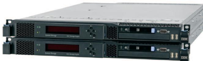
SVC поддерживает подключение к серверам с использованием протоколов iSCSI по IP-сетям со скоростью 1 Гбит/с или 10 Гбит/с, что помогает сократить расходы и упростить конфигурирование серверов. SVC также поддерживает протокол FCoE, позволяя использовать конвергированные инфраструктуры центров обработки данных; эта новая функциональность упрощает центр обработки данных и облегчает управление за счет использования одной сети для сетей хранения данных, глобальных (WAN) и локальных (LAN).
